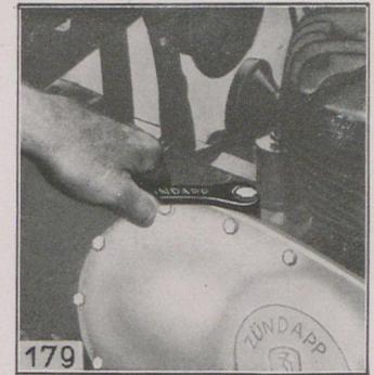
Öffnen der Öleinfüllschraube zum Getriebe.
