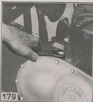
Öffnen der Oeleinfüllschraube
